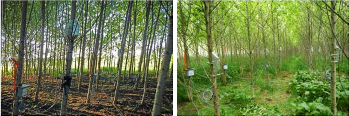
Abbildung 8: Saftflussmessungen mit TDP-Sensoren; links: Löss-Standort; rechts: Schotter-Standort
