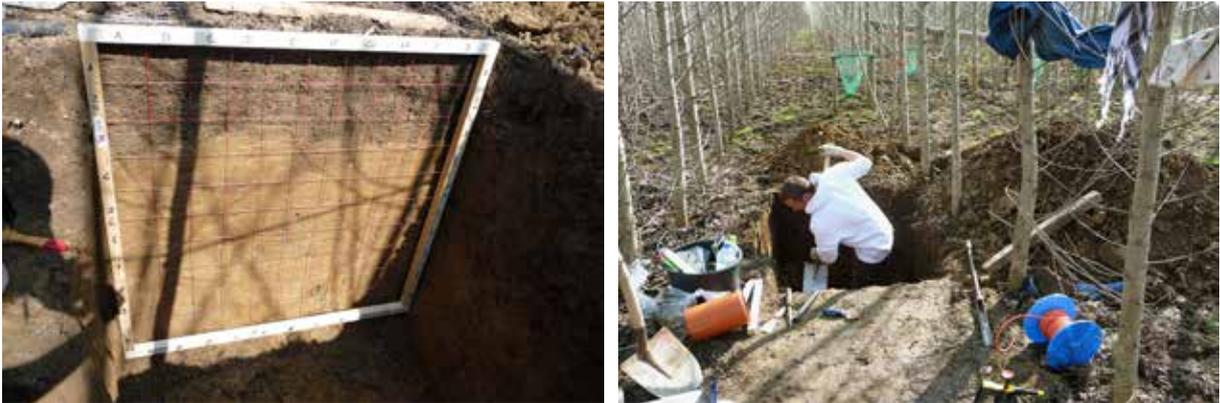
Abbildung 6: Bestimmung der Durchwurzelungsintensität (Wurzelspitzen pro  $\text{dm}^2$ )
