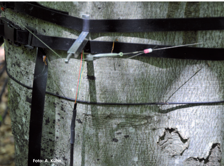
Abbildung 1: Elektronisches Dendrometer zur Bestimmung des Radialzuwachses (DC2, Ecomatik)
