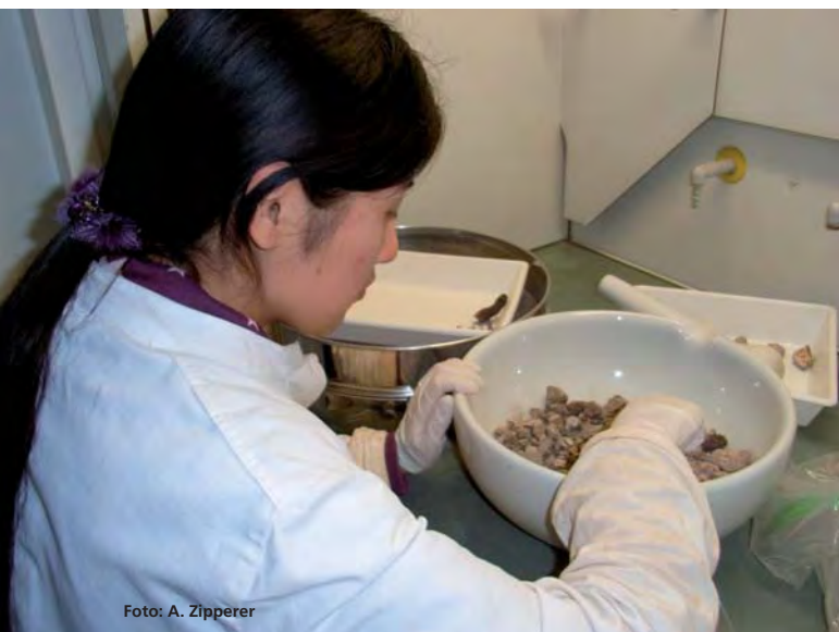
Abbildung 2: Aufbereitung einer Bodenprobe im Mörser für die anstehende Siebung zur Ermittlung des Skelettanteils
