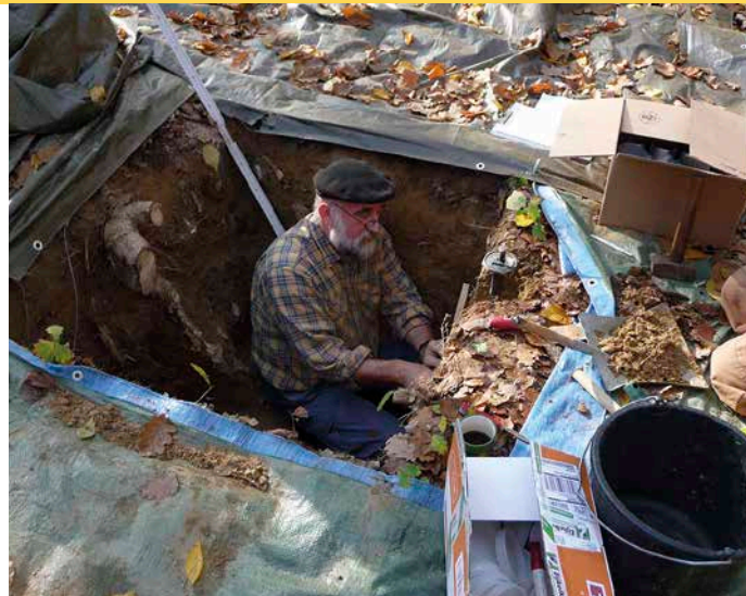
7 Ferry Grimmeisen (LWF) beim Einbau von Temperatur- und Feuchtsensoren auf der Waldklimastation Würzburg, eine der sechs Schwerpunktstationen, an denen zusätzlich Bodenfeuchtigkeit und Bodentemperatur gemessen werden Foto: H.-J. Krause, LWF
