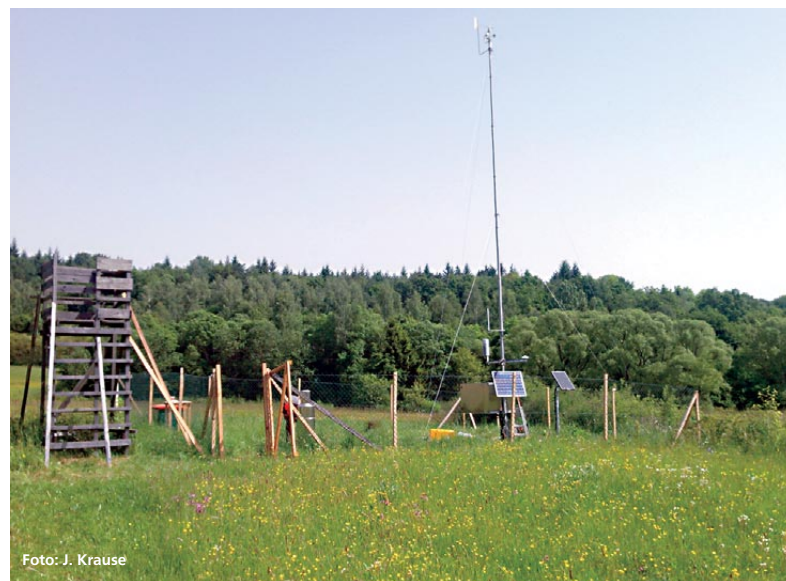
Abbildung 2: Die Freilandmessstelle liefert wichtige meteorologische Kenngrößen, aber auch Schadstoffeinträge.
