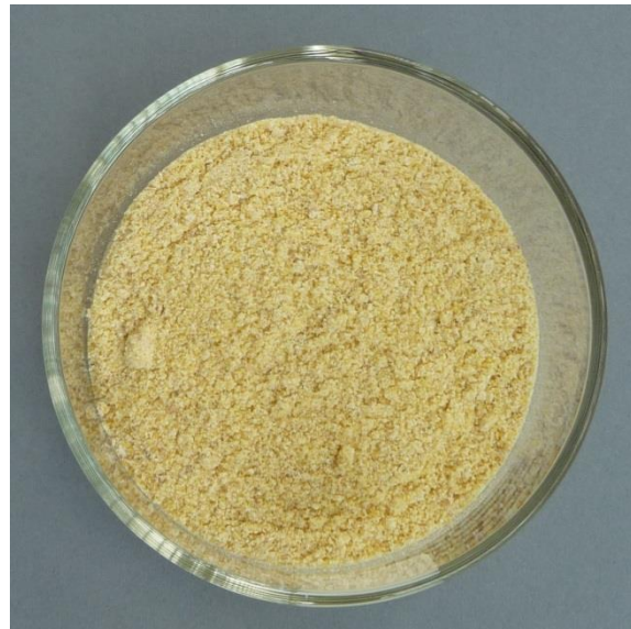
Abb. 46: Homogenisierte Maismehlprobe aus einer Laborvergleichsuntersuchung zur Bestimmung von Trichothecenen
