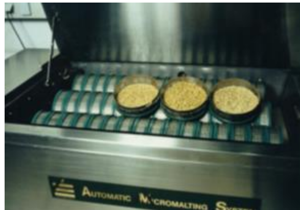
Abb. 8: Kleinmälzerei in AQU. Die Untersuchungen zur Bewertung der Gerstenmalzqualität werden mit akkreditierten Methoden durchgeführt.
