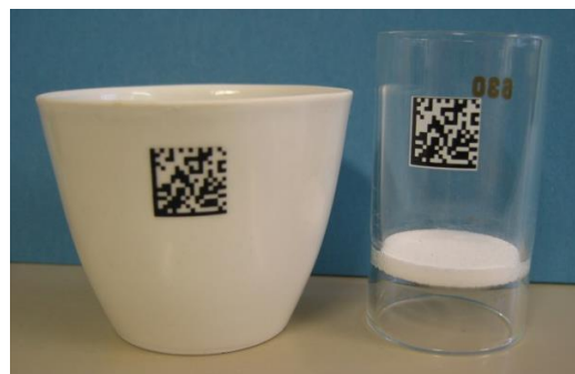
Abb. 79: Asche- und Rohfasertiegel mit Barcodeidentifizierungen für Probenerfassung im Labor
