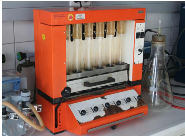
Abb. 75: Analysengerät zur Bestimmung des Fasergehalts in Futtermitteln
