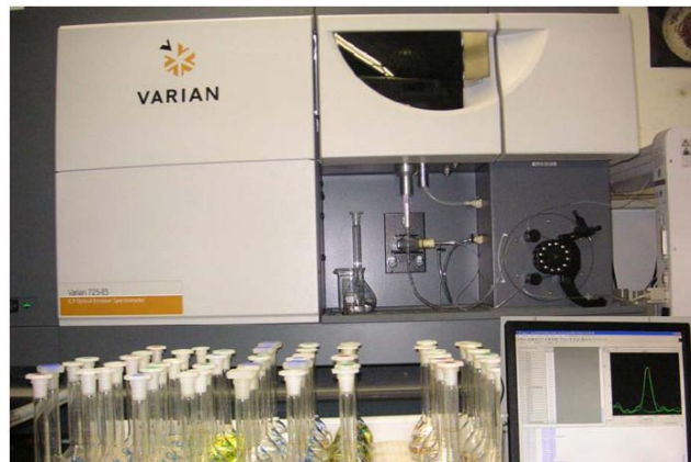
Abb. 23: Königswasserauflösungen von Düngemitteln zur Multielementanalyse am ICP-OES
