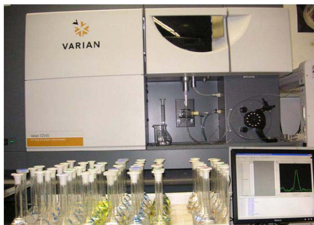
Abb. 14: Königswasseraufschlüsse von Düngemitteln zur Multielementanalyse am ICP-OES
