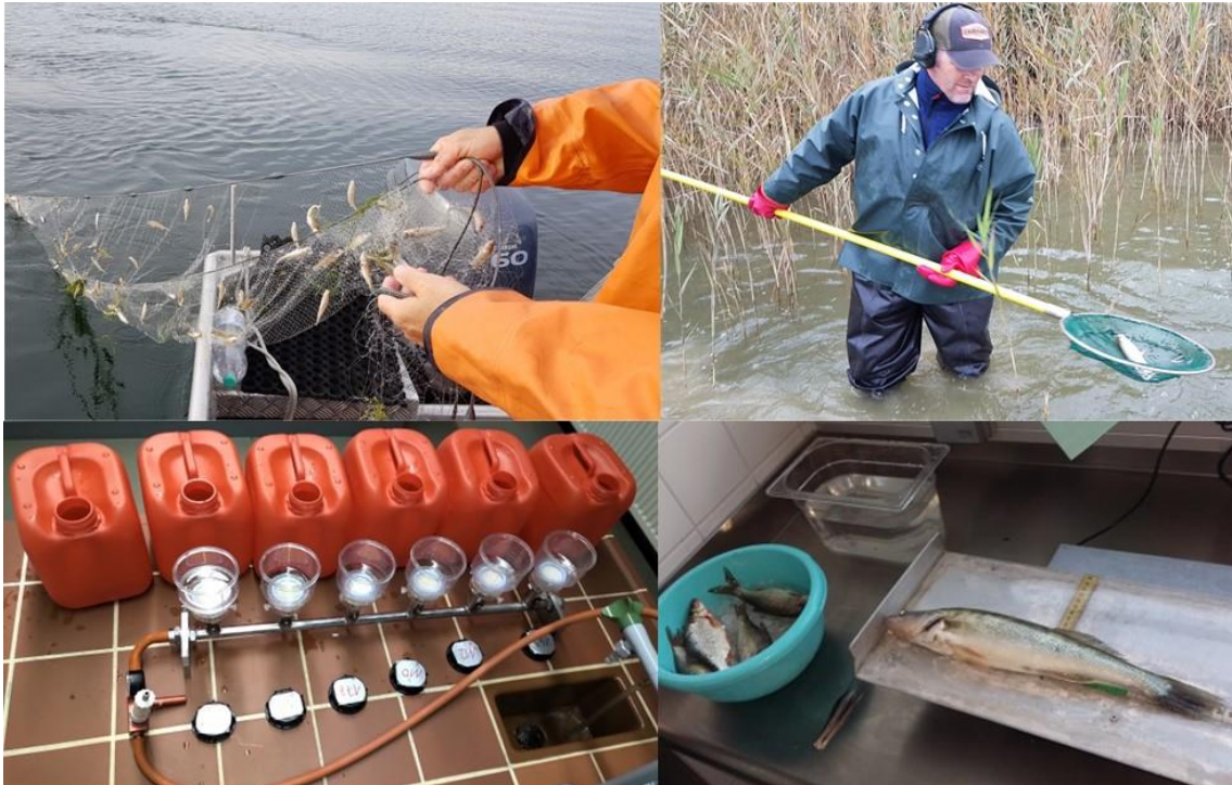
Abb. 3: Die Erfassung des Fischarteninventars im Starnberger See erfolgt über Netz-, Elektrofischerei, sowie eDNA-Analysen aus vorfiltrierten Wasserproben (Fotos: links oben M. Schubert, LfL; rechts oben M. Teichert, LfL; unten C. Vogelmann, LfL)
