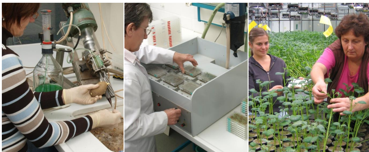
Abb. 1: Bei Pflanzgut der Kategorie Z und Privatproben erfolgt in der Regel der Virusnachweis mittels ELISA am Kartoffelkeim; links: Pressen der Keime, Mitte: Waschen der ELISA-Platten). Bei Vorstufen und Basispflanzgut werden Augenstecklingspflanzen untersucht
