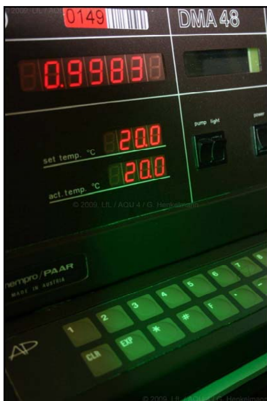
Abb. 18: Dichtemessgerät zur Vermessung der „Würze“
