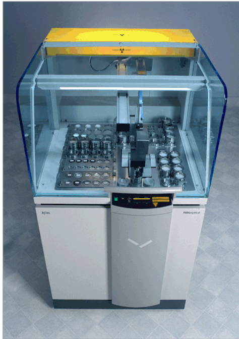
Abb. 23: Röntgenfluoreszenz - Spektrometer zur Elementuntersuchung
