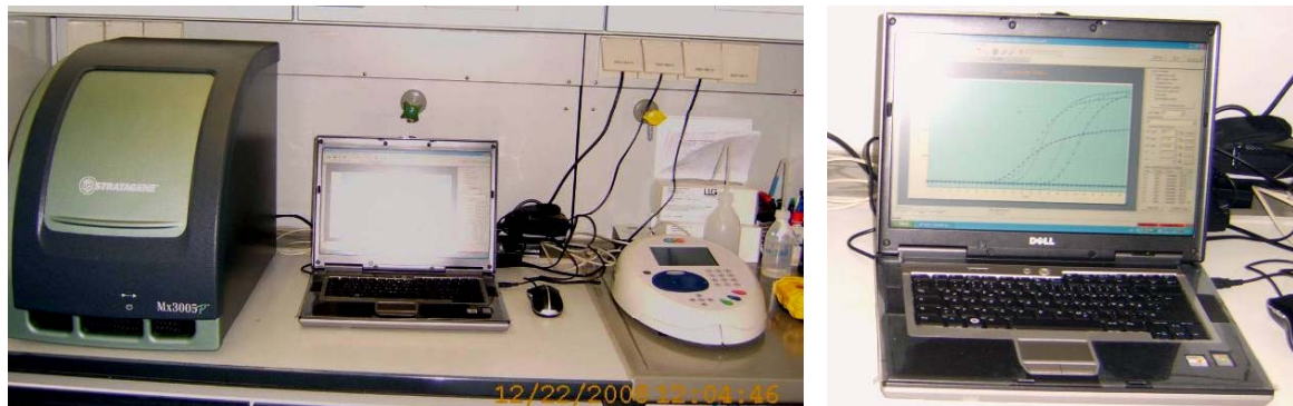
Abb. 14: Ausrüstung zur quantitativen Real-Time PCR-Analytik und Gerät zur Messung der Absorptionsspektren geringster Nukleinsäuremengen
