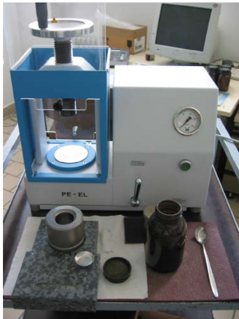
Abb. 24: Herstellung der Probenpresslinge für die Mineralstoffbestimmung mittels Röntgenfluoreszenz.
