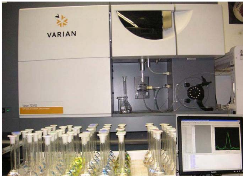
Abb. 6: Königswasserauflösungen von Düngemitteln zur Multielementanalyse am ICP-OES
