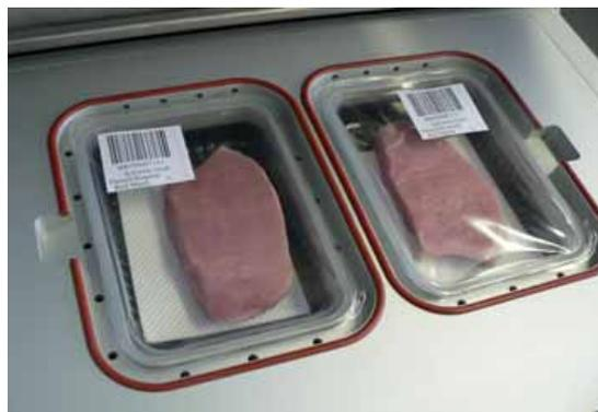
Abbildung: Traysealer der Firma Komet mit schutzgasverpackten Referenzproben im Labor der AQU Grub
