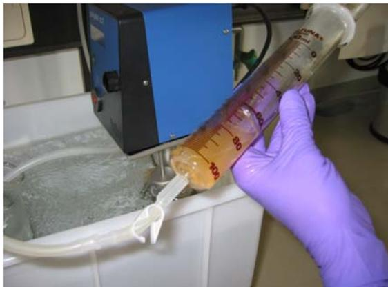
*Befüllen des Inkubationskolbens mit der Nährlösung aus Pufferlösung und frischem Pansensaft*
