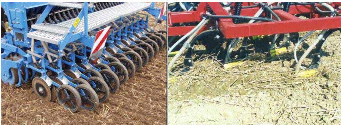
Abb.: Scheibenschar mit Andruchrollen, für exakte Saatguteinbettung, Grubberschar mit Zuleitungen für Saatgut und Dünger
