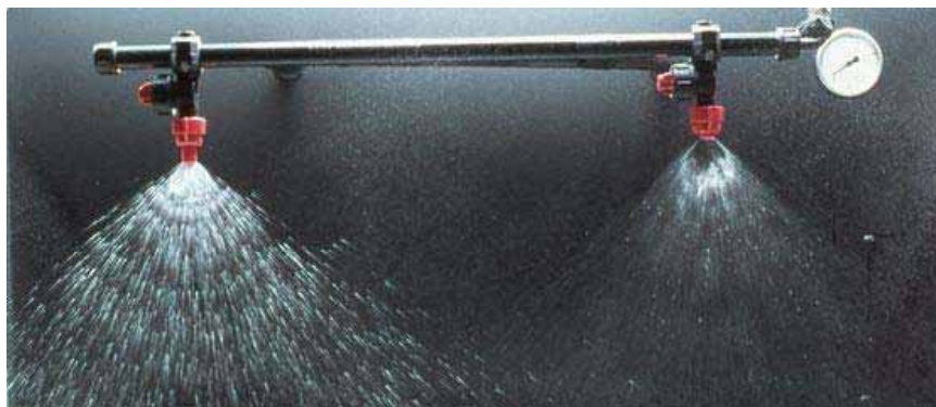
Spritzbild einer abdriftreduzierten, grobtropfigen Luftinjektordüse (links) und einer feintropfigen Standarddüse (rechts)
