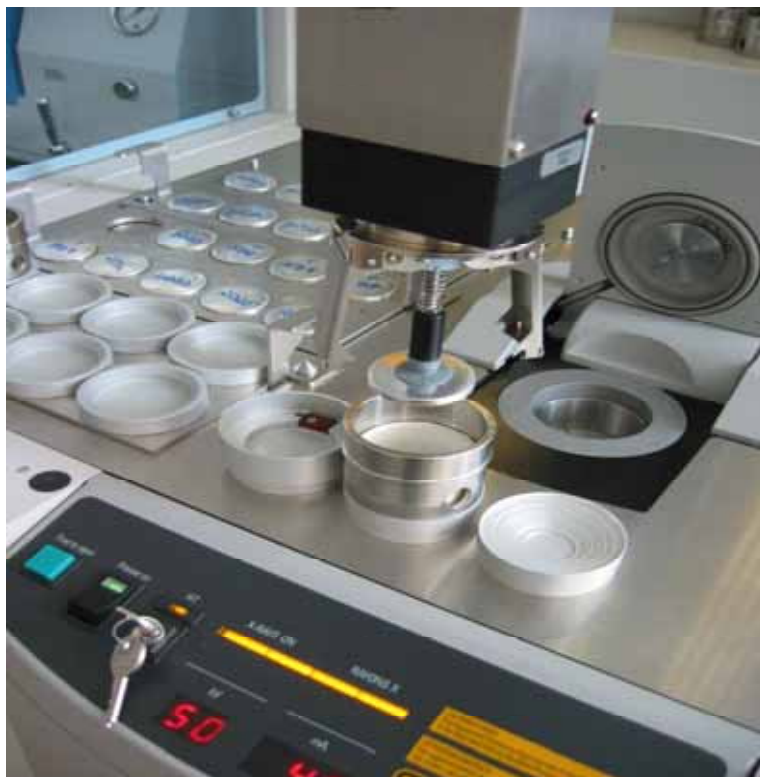
Röntgenfluoreszenz-Spektrometer der Fa. Panalytical mit Probenpresse
