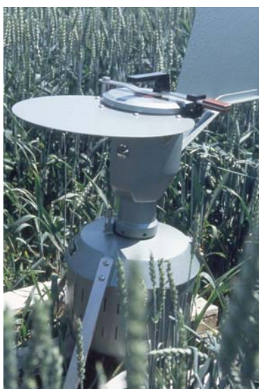
Burkard-Sporenfalle in einem Weizenbestand zur Erfassung des Sporenflugs von Pilzen der Gattung Fusarium
