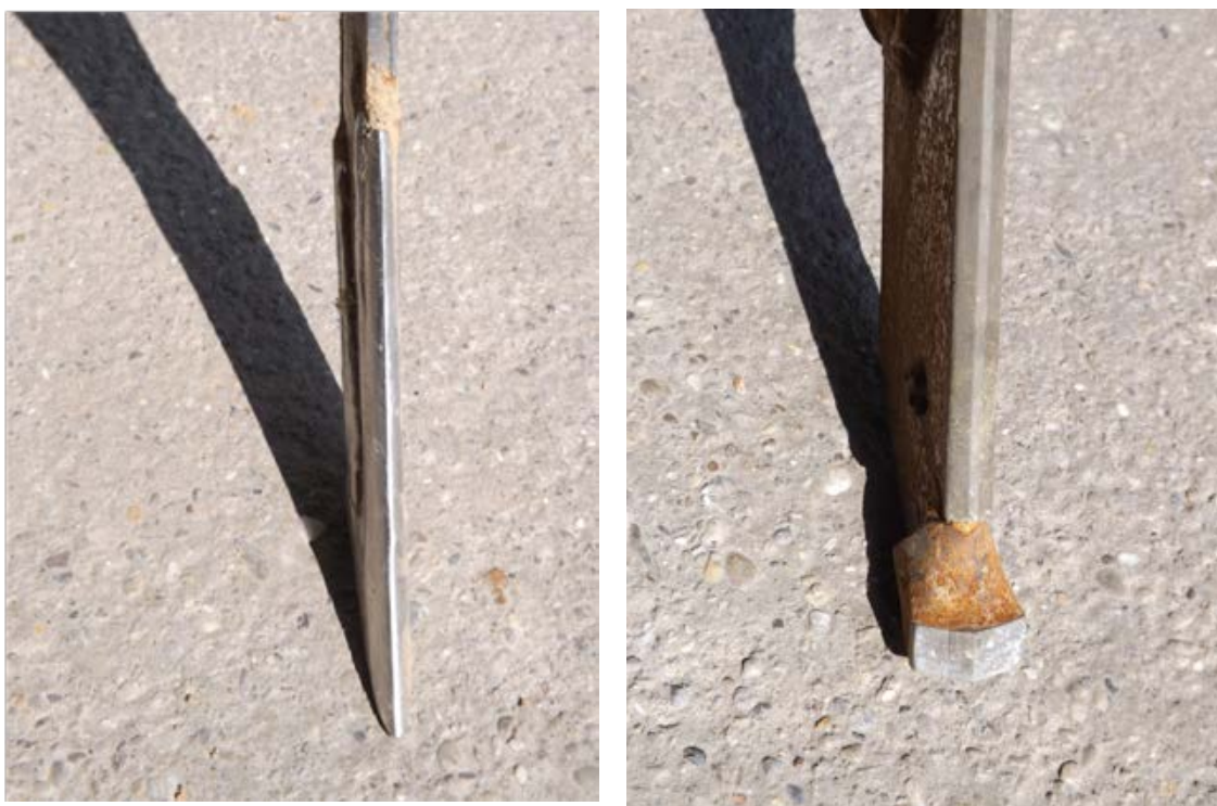
Abb. 19: Links: 20mm breites Messerschar, Rechts: 40 mm breites Meißelschar.
