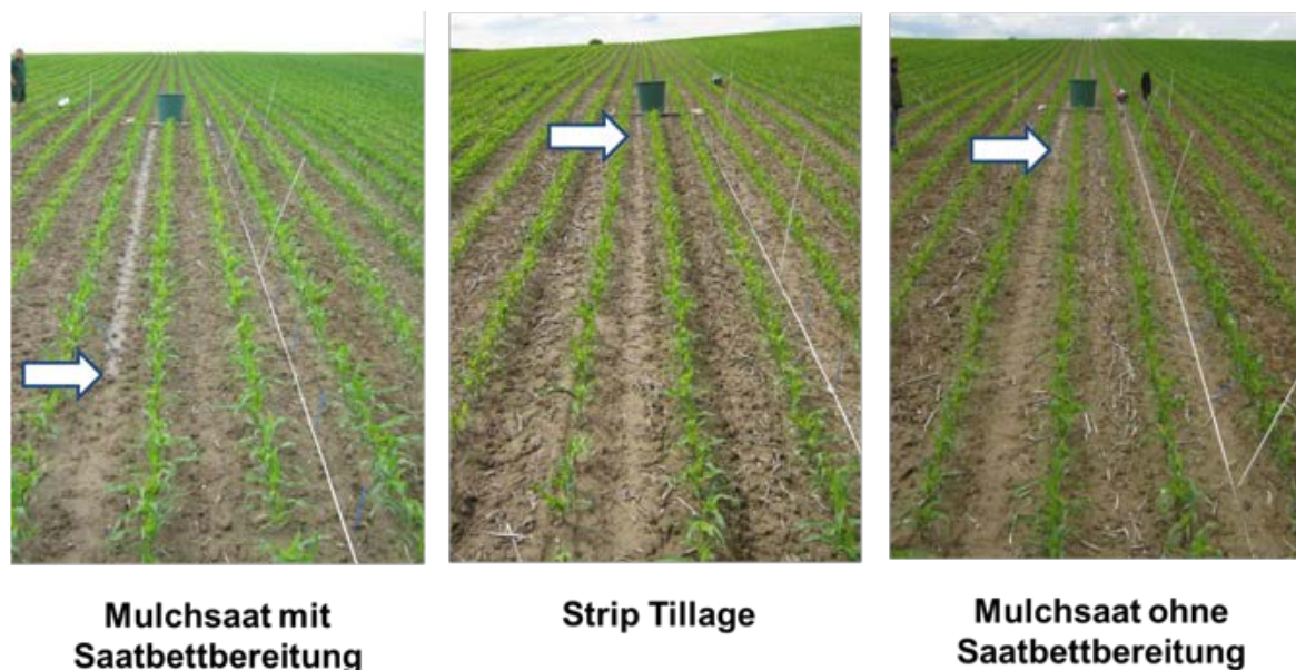
Abschwemmversuch 200 l in 12 Min.
