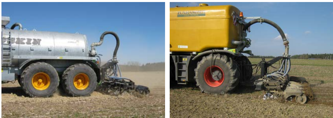
Abb. 17: Links: Anbau sechsreihiges Streifenbodenbearbeitungsgerät an einem gezogenen Güllefass, Rechts: Anbau sechsreihiges Streifenbodenbearbeitungsgerät an einem selbstfahrenden Ausbringfahrzeug.
