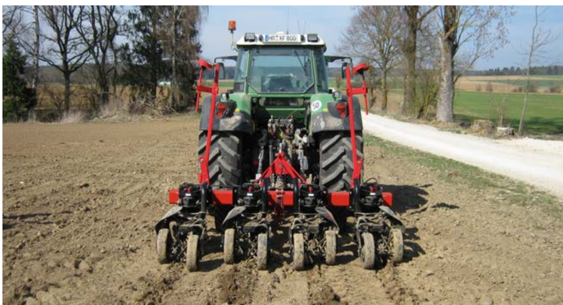
Abb. 18: Vierreihiges, dreipunktangebautes Streifenbodenbearbeitungsgerät für Demonstrationsversuche des AELF Karlstadt 2010.
