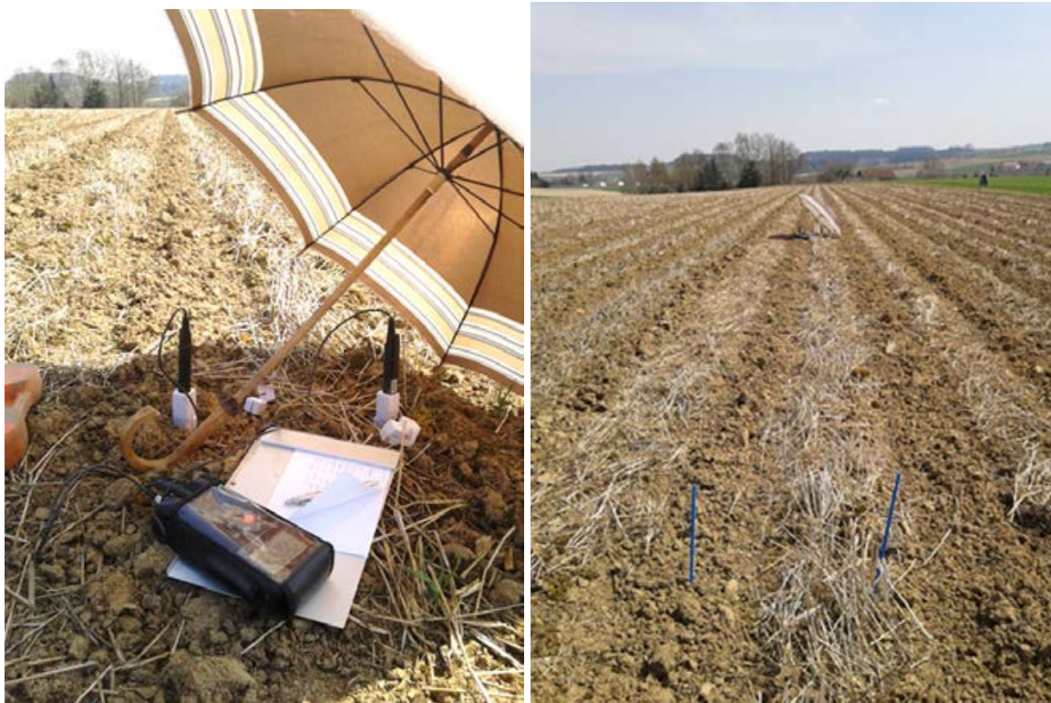
Abb. 9: 10 Messpunkte verteilt über 15 m; Messung in verschiedenen Tiefen; Lockerungsstreifen und unbearbeiteter Steg 18.04.2013; 13:00-15:00 Uhr
