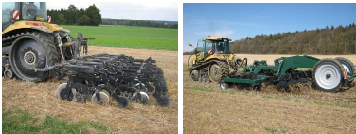
Abb. 16: Links: Einbalkiger, dreipunktangebauter Rahmen für Yetter Maverick®, jede zweite Reihe an Verlängerungsholmen montiert Rechts: zweibalkiger, aufgesattelter Rahmen für Dawn Pluribus®, jeweils für Zuckerrüben mit 45 bzw. 50 cm Reihenabstand.
