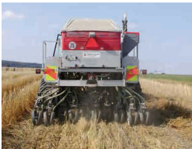
Abb. 7: Direktsaat von Raps in gestrippten Weizenbestand
