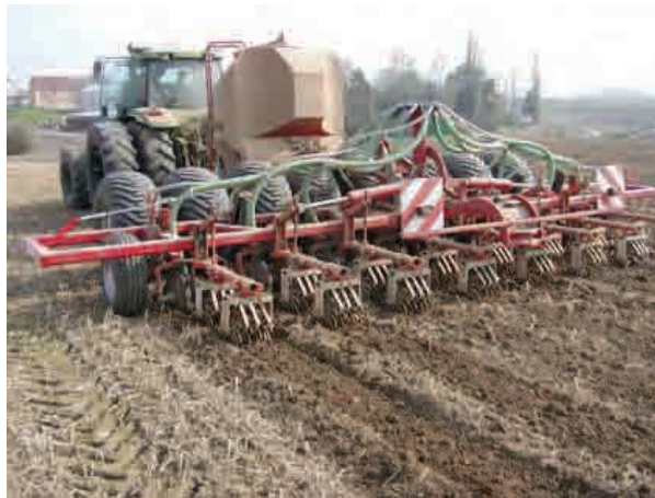
Abb. 5: Streifenbearbeitung zu Mais mit nachfolgender GPS-gesteuerter Maisaussaat
