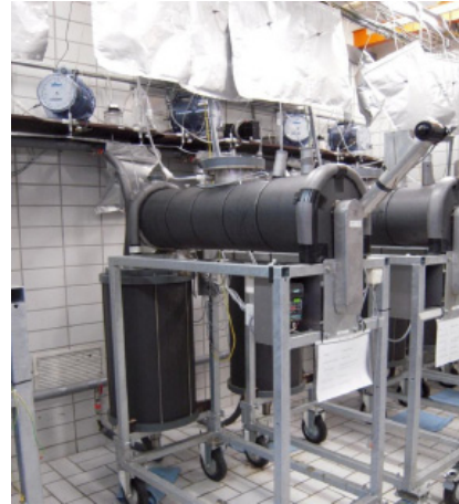
b) Zweistufiges Durchfluss System
