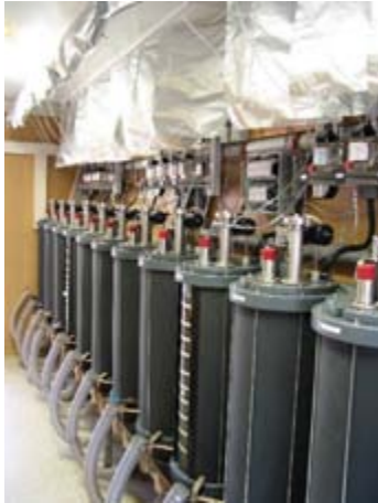
a) Einstufiges Durchfluss System
