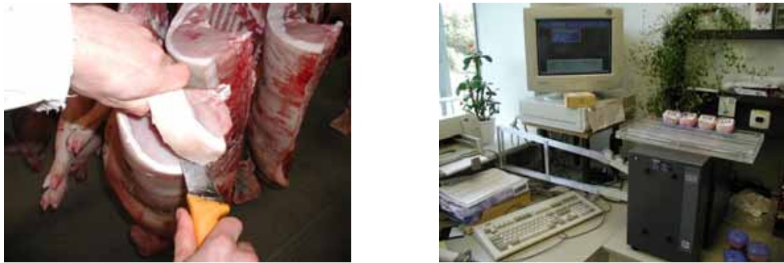
Abb. 6: Von einer Kotelettscheibe wird eine homogene Masse im NIRS-Gerät vermessen und der IMF-Gehalt ermittelt
