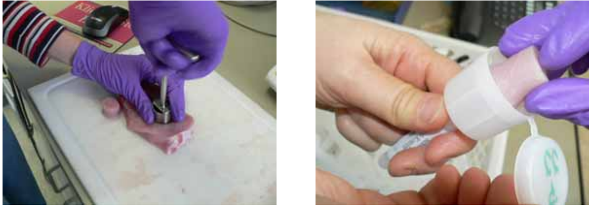
Abb. 10: Ausstanzen und Verpacken der Fleischzylinder für die EZ-Methode im Labor der AQU Grub
