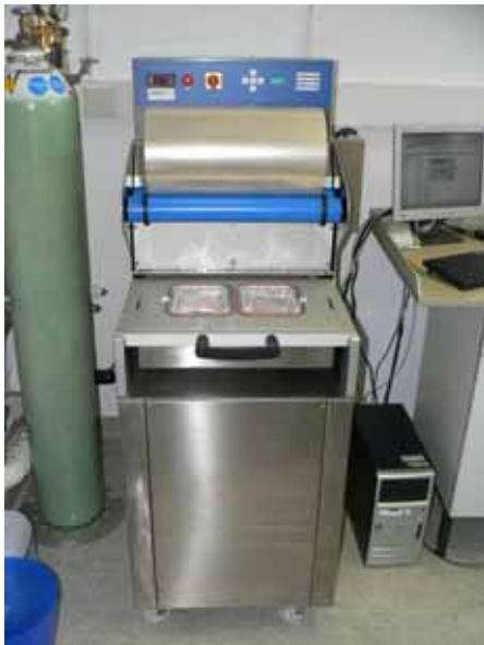
Abb. 11: Traysealer der Firma Komet mit schutzgasverpackten Referenzproben im Labor der AQU Grub
