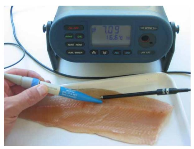
Abbildung 13: pH-Wert-Messung am Fischfilet (links: pH-Einstichelektrode, rechts: Temperaturfühler)
