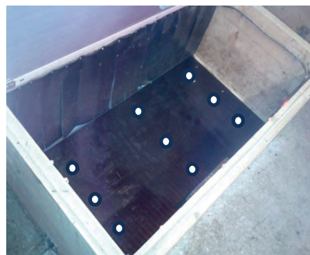
Abb.2: Messung der Temperaturverteilung mittels 9 Sensoren
