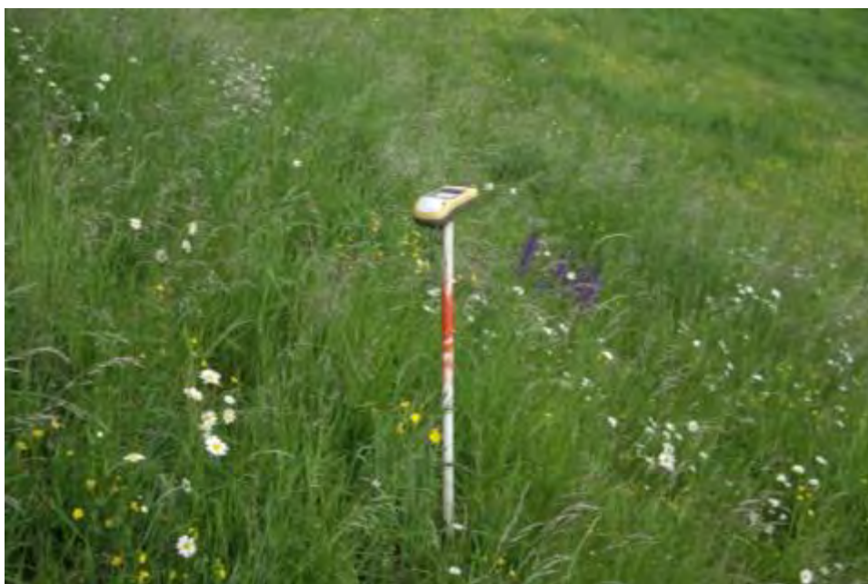
Abb. 3: Einmessen des Mittelpunktes einer Wiederholungsfläche mit dem GPS-Gerät (Foto S. Springer).
