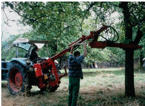
Der Hydraulikschüttler HSA-10 von LIPCO im Einsatz
