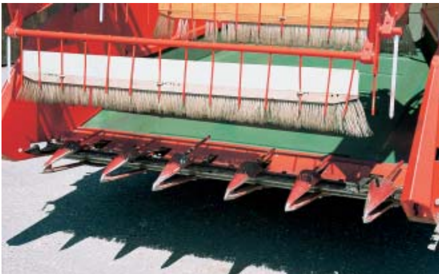
Torpedofruchtheber am Grüngüternter für niederliegende Pflanzenarten
