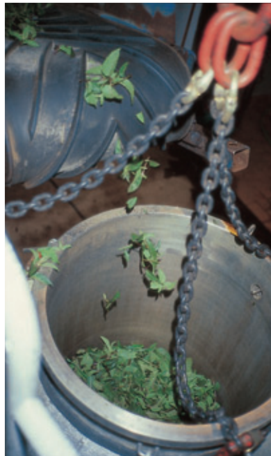
Abbildung 9: Destillationsblase der Versuchsanlage beim Befüllen
