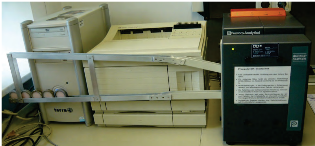
Abbildung 21: NIRS-Gerät mit Probenzufuhr von links
