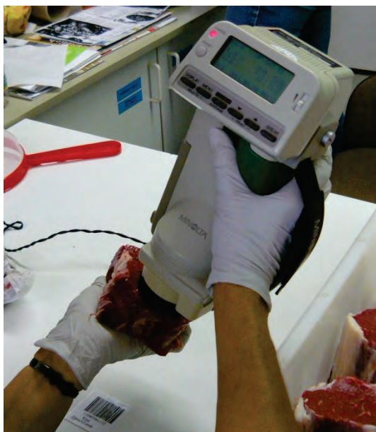
Abbildung 14: Messung der Fleischfarbe mit der MINOLTA-Kamera
