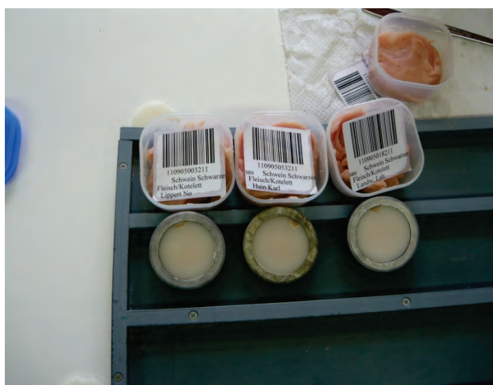
Abbildung 20: Vermusste Fleischproben mit Barcodes und befüllte Küvetten
