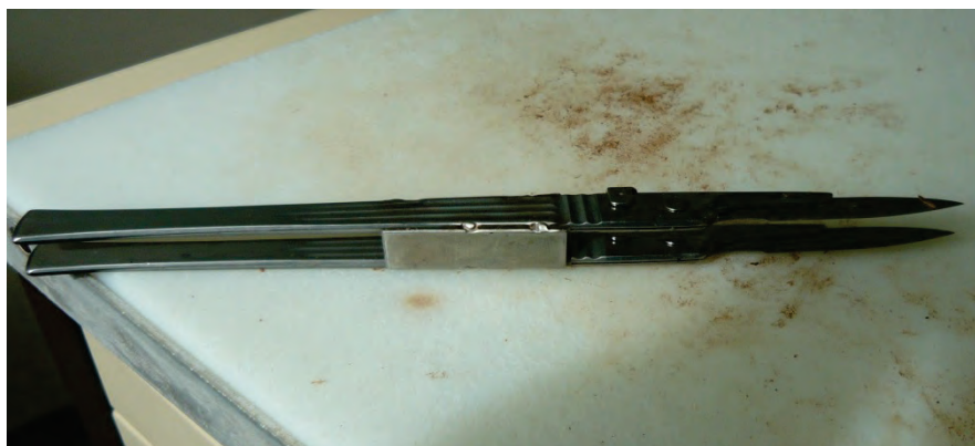
Abbildung 16: Doppelmesser-Skalpell zum Schneiden der Fleischquader
