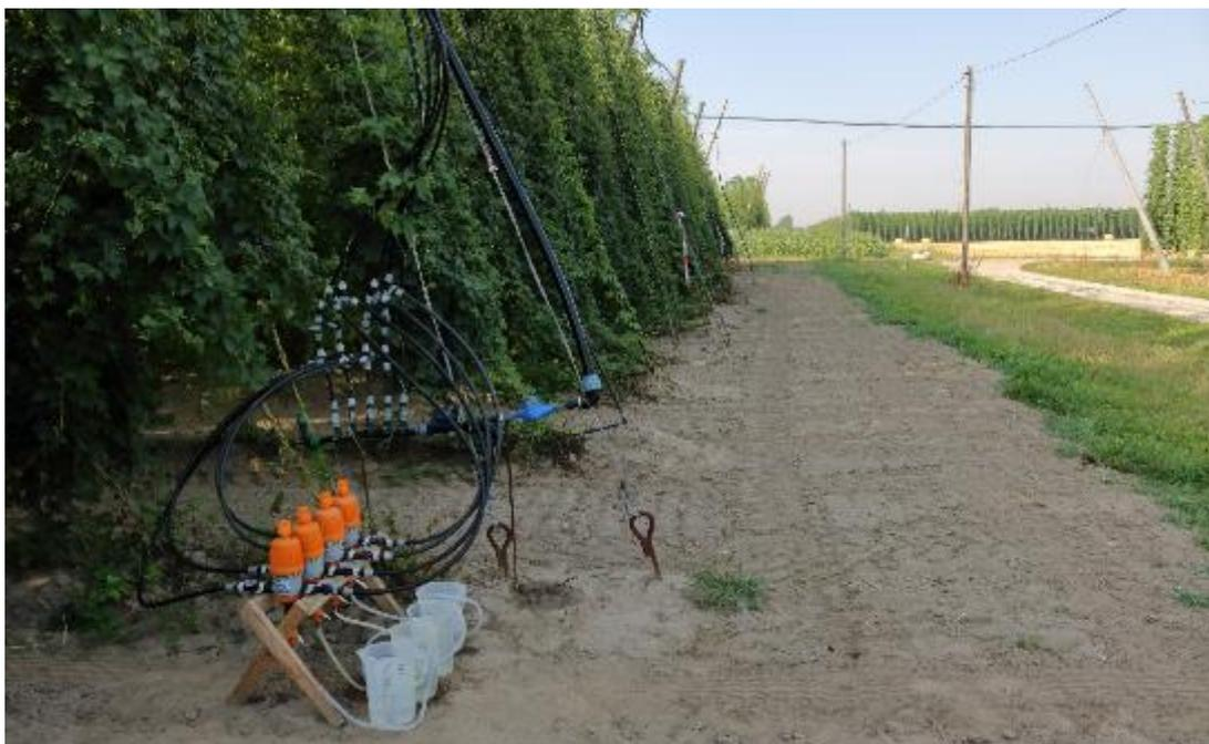
Abb. 4.1: Versuchsaufbau zur Bewässerung mit Fertigation
