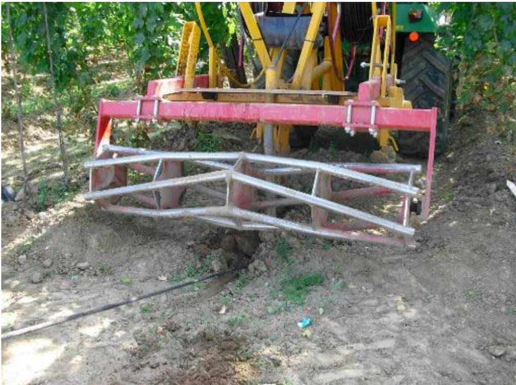
*Abb. 3.16: Installation des Tropfschlauches in der Fahrgassenmitte.*
