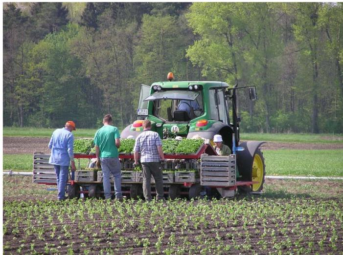
**Abbildung 22:** Pflanzmaschine (6-reihig)
