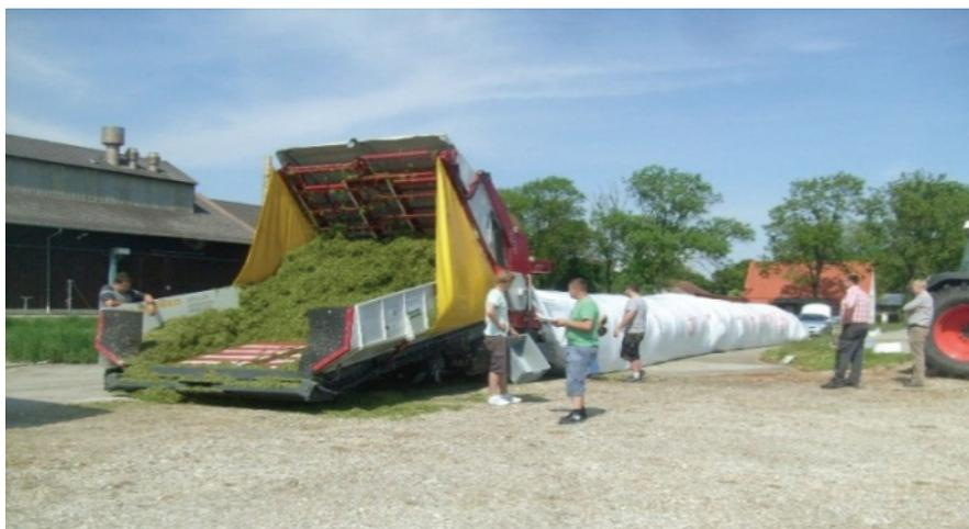
**Abb. 5: Silage im Folienschlauch**
