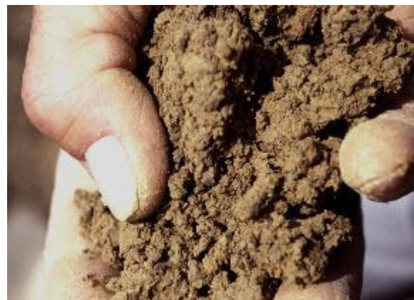
Abb. 15: Durch Zerdrücken mit der Hand werden Festigkeit und Zerfall der größeren Aggregate geprüft
