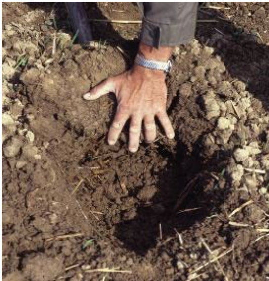
Abb. 11: Ausheben des Bodenblocks: Die eine Hand betätigt den Spaten als Hebel, die andere hält den Bodenblock auf dem Spatenblatt
