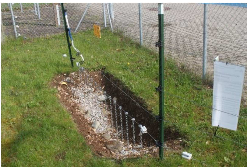
Abbildung: Bachquerung mittels Kettenvorhang und Energiebegrenzer. (© Dr. Mendel)
