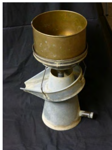
Fenwick-Kanne zur Extraktion von Nematoden
