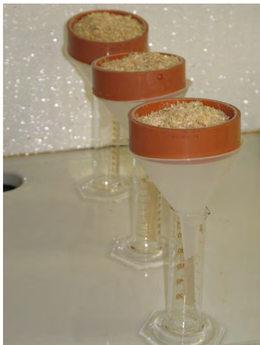
Sprühnebelanlage zur Extraktion von Nematoden aus Pflanzenteilen
