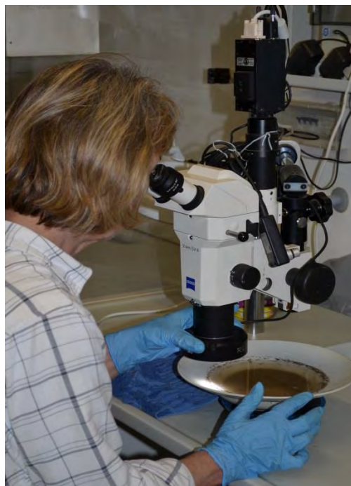
Nematoden-Zystenbonitur mit der Tellermethode
