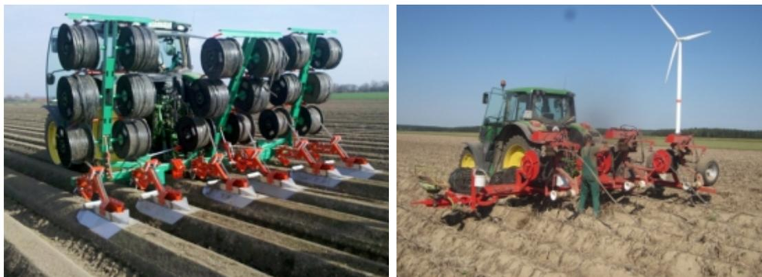
*Prototyp des 6-reihigen Verlegegerätes für Tropfschläuche mit hydraulisch absenkbar
