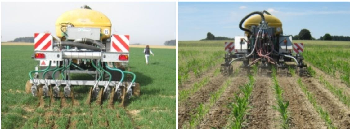
*Versuchsgüllefass mit tief arbeitender Scheibentechnik im Winterweizen (links) und mit 5-reihigem Strip-Till Gerät im Maisbestand (rechts) zur Ausbringung flüssiger Wirtschaftsdünger*
