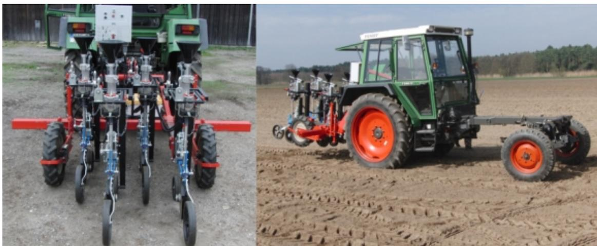
*Auf vierreihige Aussaat angepasste, elektrisch angetriebene und elektronisch gesteuerte Sämaschine für Heil- und Gewürzpflanzen der LfL (links); Sämaschine im Heckanbau während der Erprobung (rechts)*
