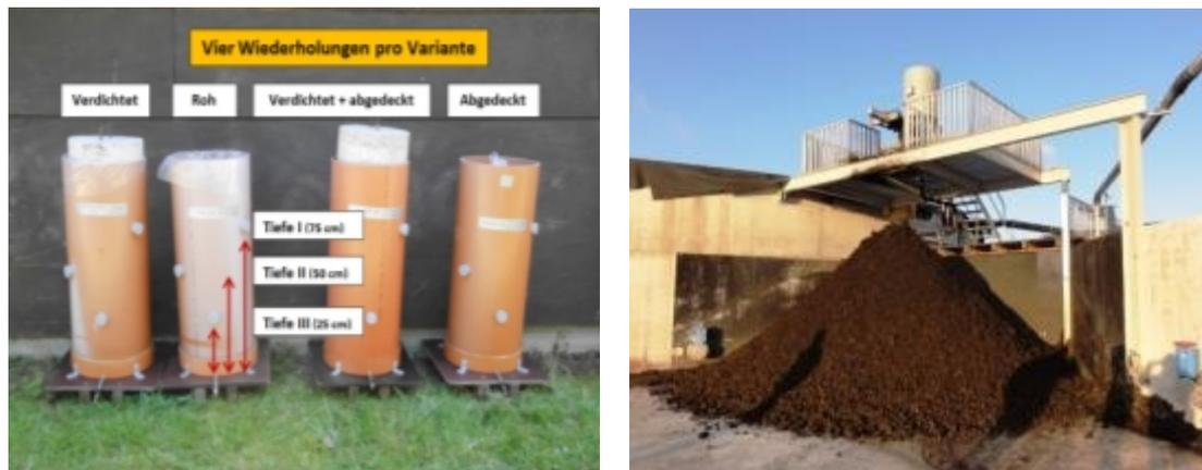
*Darstellung der Versuchsvarianten und des -aufbaus zur Bewertung der vier unterschiedlichen Verfahren zur Lagerung von festen separierten Gärresten (links); Blick auf einen markgängigen Pressschneckenseparator (rechts)*
