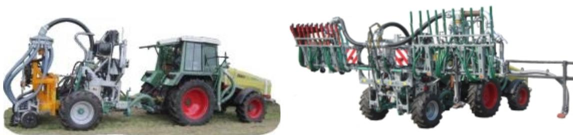
*Versuchsparzellengüllefass mit Injektionseinheit (links) und Ausbringkombination Schleppschuh-, Schleppschlauch-, Prallplattenverteiler (rechts)*
