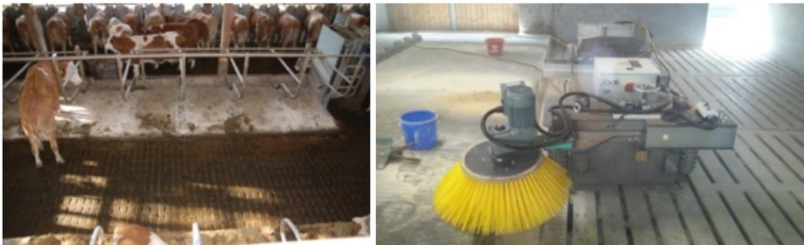
*Versuchsträger mit Reinigungs- und Einstreumodul (rechts), um verschmutzte Hochboxen im Milchviehstall (links) zu pflegen*
