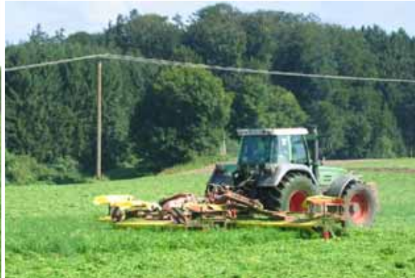
Traktorangebaute Dreifach-Mähkombination in Traktorschubfahrt mit Rückfahreinrichtung
