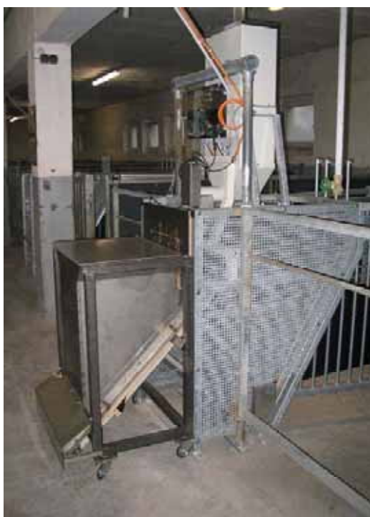
Kombinierter Futterstand für Prüfämmer und Mutterschafe mit Grundfutterdosierförderer und Kraftfutterdosierer
