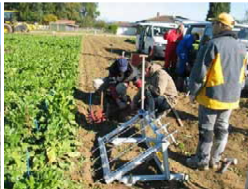
Die Bodenbeanspruchung wird mit Schlauchdrucksonden gemessen
