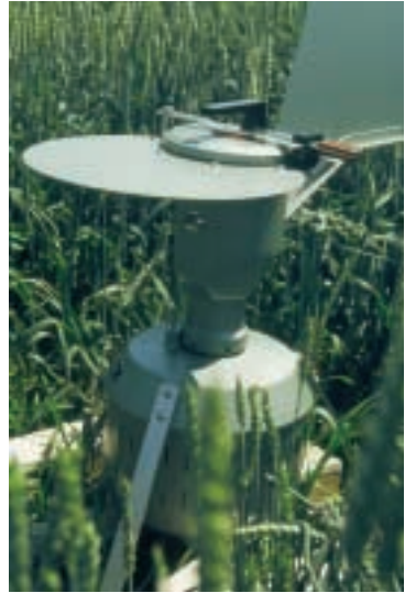
Burkard-Sporenfalle zur Erfassung des Sporenflugs von Fusarien
