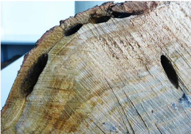
Abb. 5: Bohrgänge im Holz
