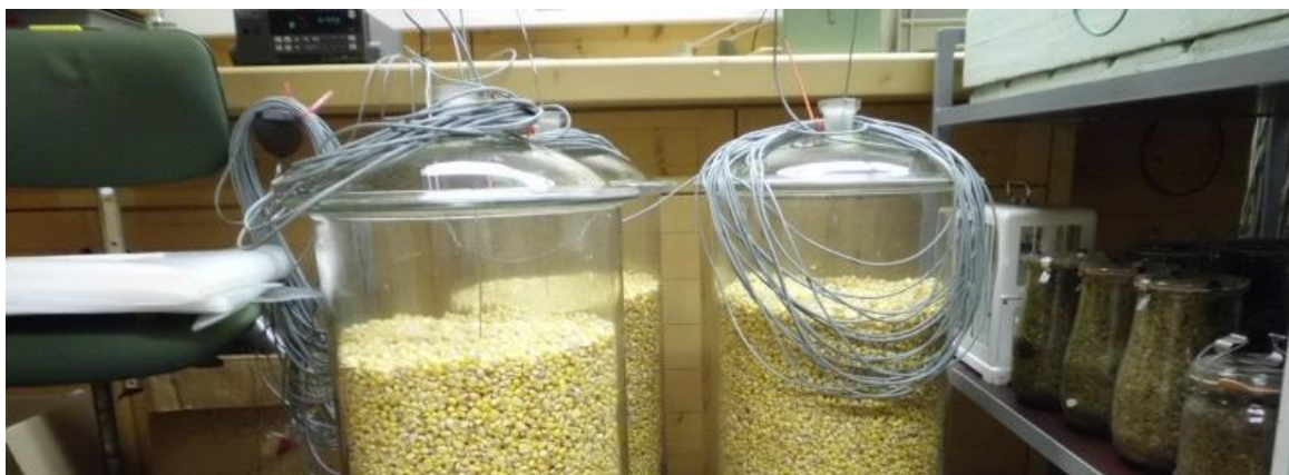
Feucht eingelagerter Körnermais, versehen mit Temperaturfühlern
