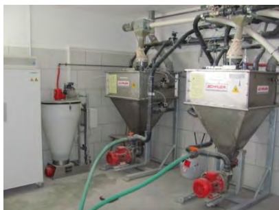
Flüssigfütterungsanlage mit Kleinstmengen dosierer (links) zur Inulingabe
