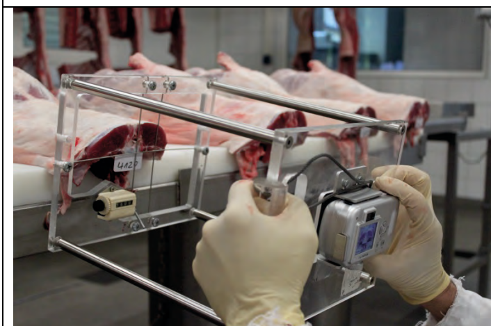
Abb. 2: Für die Kotelettflächenvermessung werden digitale Fotos verwendet. Der gleiche Abstand/Standard ist Voraussetzung.
